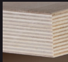
Multistrato di pioppo Spessore: 38 mm Strati: 25
